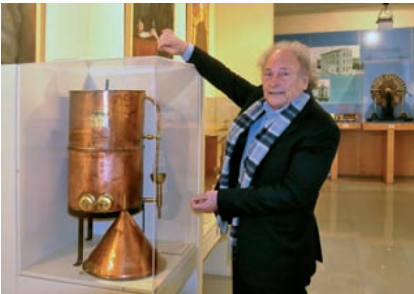
Punset en el Museo IQS, junto al destilador continuo de agua diseñado por el P. Vitoria y fabricado en 1920
